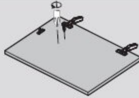
Установка крепления к фасаду
