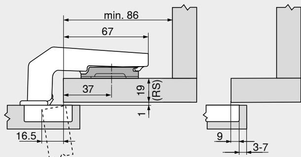
Минимальный зазор F для фасадов с радиусом (R = 1 мм) при заводской настройке
