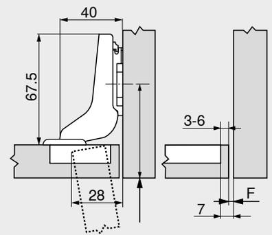
Расстояние (от края) до места крепления ответной планки увеличивается на толщину фасада FD +1.5 мм
