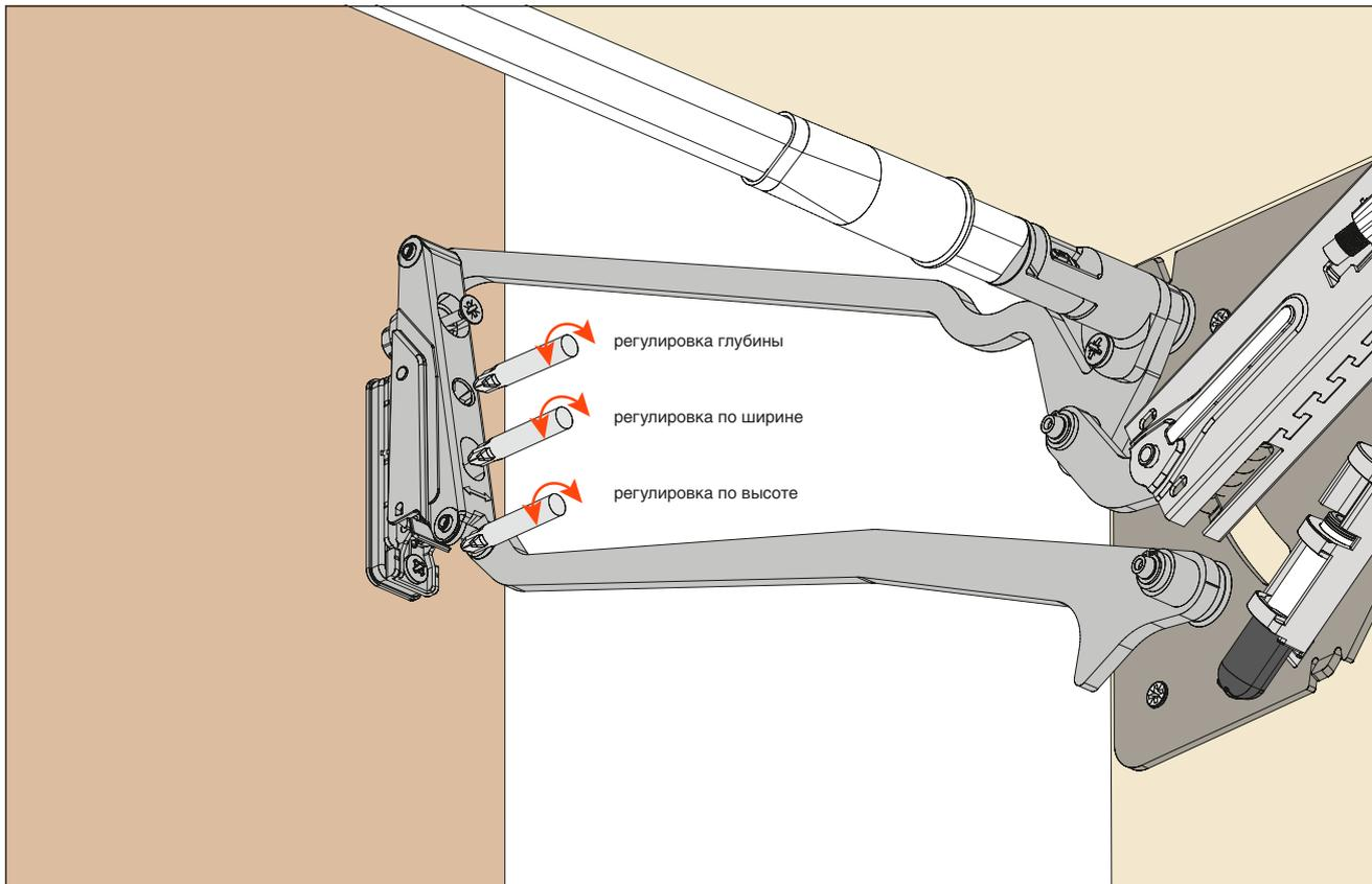
8. После окончания регулировки фасада производим финальную фиксацию фасада.
