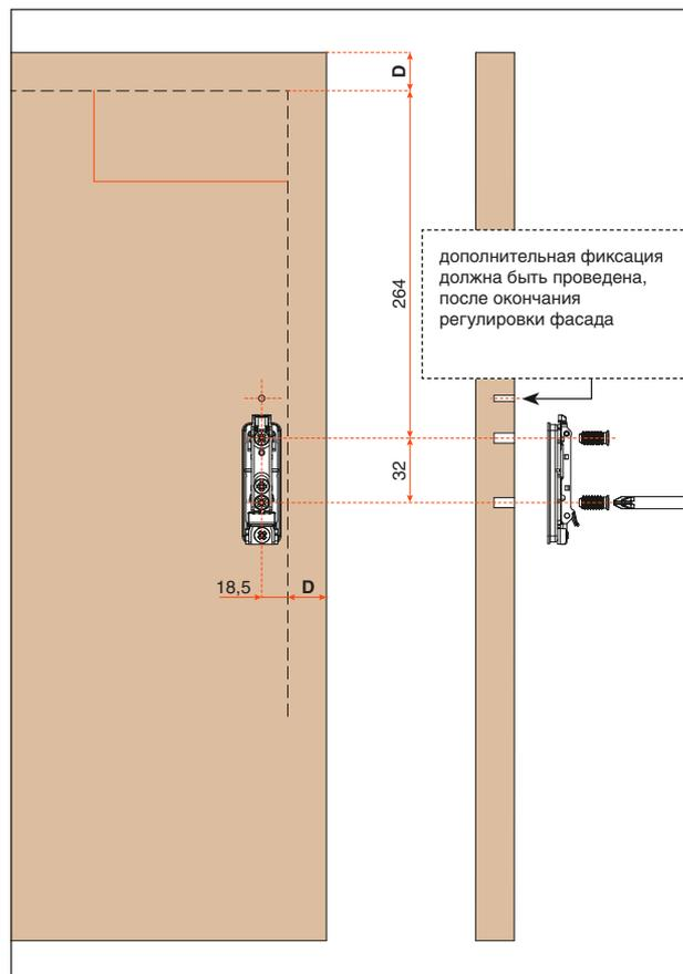
Схема присадки фасада для каркасов высотой от 440 до 600 мм.
