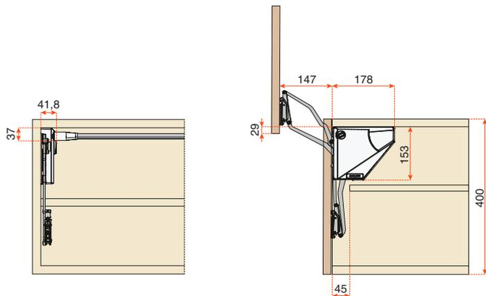
Для каркасов высотой от 440 до 600 мм.
