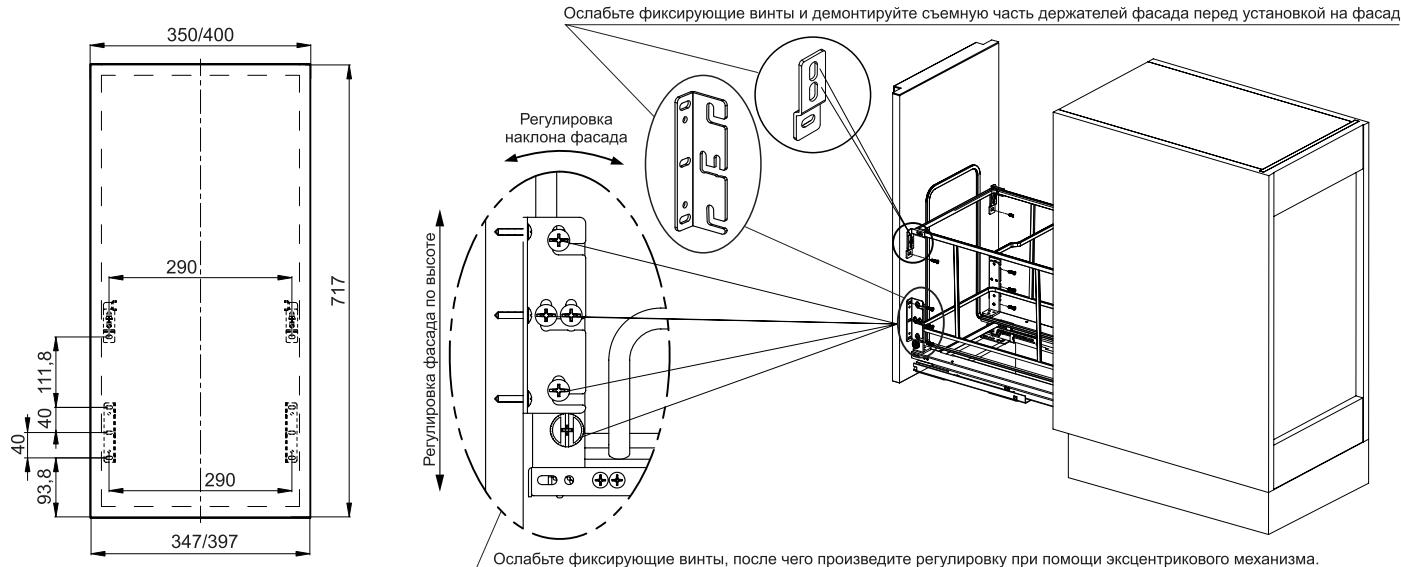
6 После окончательной регулировки, закройте нижние держатели фасада декоративными заглушками E и установите пластиковые вёдра B в корзину.
