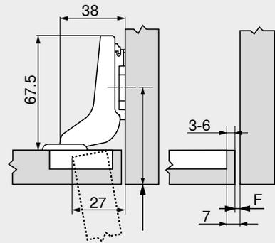
Расстояние (от края) до места крепления ответной планки увеличивается на толщину фасада FD +1.2 мм
