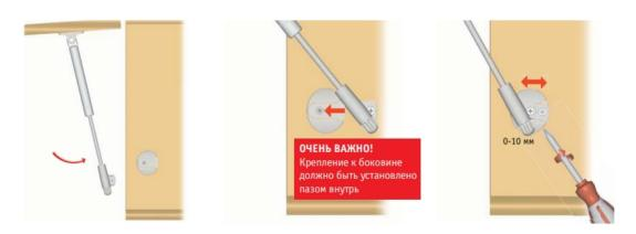
Открывание и закрывание двери может быть отрегулировано позицией лифта в креплении к боковине:
