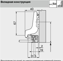
Расстояние (от края) до места крепления ответной планки увеличивается на толщину рамки +1.7 мм
